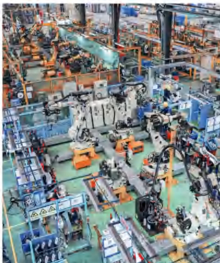
2017年2月22日，江苏省太仓市伍享汽车配件有限公司自动化焊接车间内，60多台工业机器人正在生产线上焊接汽车横梁
